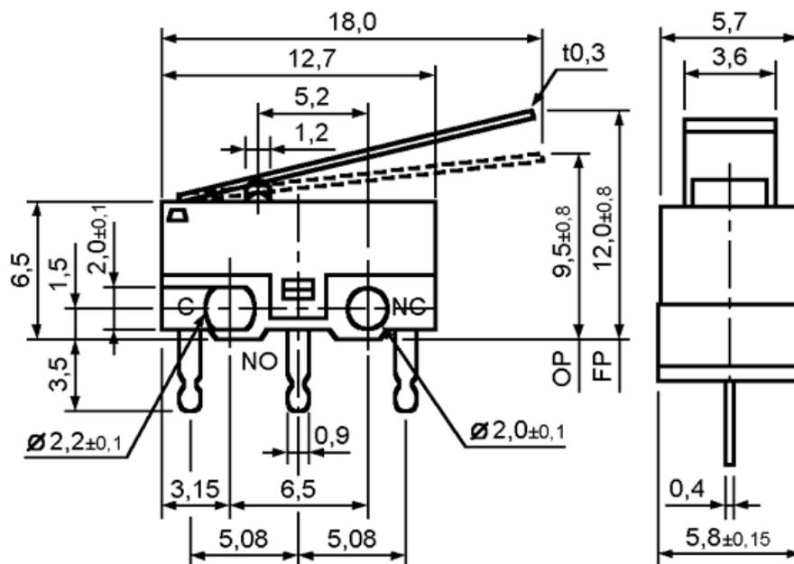
Рис.2 Габаритные и присоединительные размеры корпуса тампера
